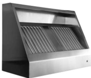
Hottes statique construction monobloc en **acier inox 18/10 AISI 304** avec film de protection d'épaisseur 8/10° en face externe et assemblée par pointage électrique. Le pliage des arêtes vives leur confère une grande sécurité passive. Bords arrondis. Goulottes spéciales anti-dégouttement et robinet d'écoulement pour le recueil des graisses. Équipées de filtres à choc à chicanes en **acier inox AISI 304**.
