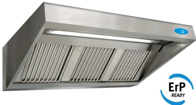
**Hottes monobloc entièrement équipées** avec ventilateur, variateur encastré et luminaire adapté encastré dans support inox. Construites en **acier inox 18/10 AISI 430** satiné scotch-Brite et soudées par pointage électrique. Le pliage des arêtes vives leur confère une grande sécurité passive. Bords arrondis. Goulottes spéciales anti-dégouttement et robinet d'écoulement pour le recueil des graisses. Équipées de filtres à choc à chicanes en **acier inox AISI 304**.
